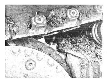
SPROKETS DE LADO DERECHO, ESTAN MUCHO MUY DESGASTADOS YA MUY FILOSOS, SE DEBEN DE REEMPLAZAR PARA EVITAR QUE EL EQUIPO QUEDE INOPERANTE DEL LADO DERECHO.
